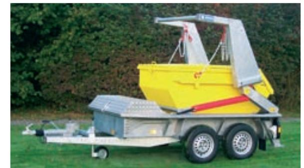
Absetz-Anhänger Typ A mit hydraulischem Teleskop und zwei hydraulischen Abstützungen
