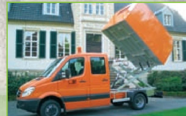
So ermöglicht das ölhydraulische Dreiseitenkipperwerk mit Teleskopzylinder links- bzw. rechtsseitiges Abkippen zusätzlich zum Heckkippvorgang.
