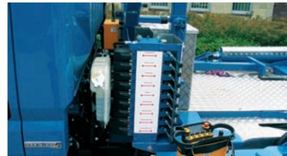
Bedienhebel vertikal angesetzt in Kombination mit Funkfernbedienung.
