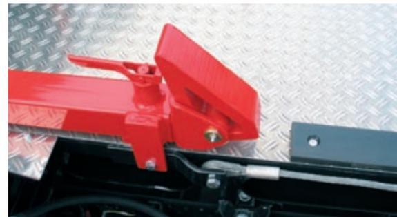
Schwenkbarer Frontstopper - die Neigung des Containers wird automatisch eingestellt.
