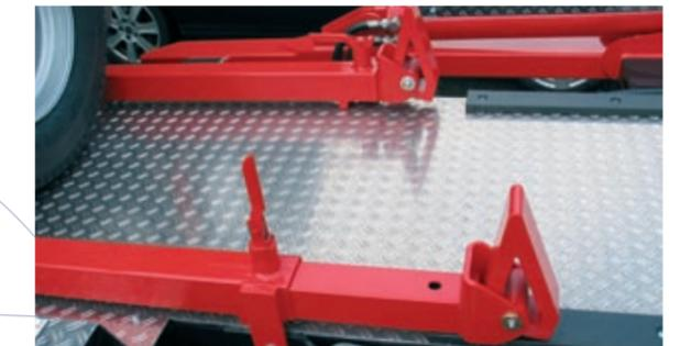
Der Frontstopper ist für verschiedene Containergrößen einstellbar. Optional auch hydraulisch betätigt.
