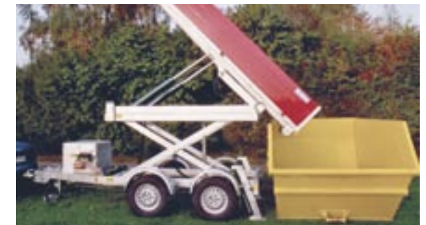
Alle Funktionen des Abroll-Anhängers sind hydraulisch und zentral steuerbar.
